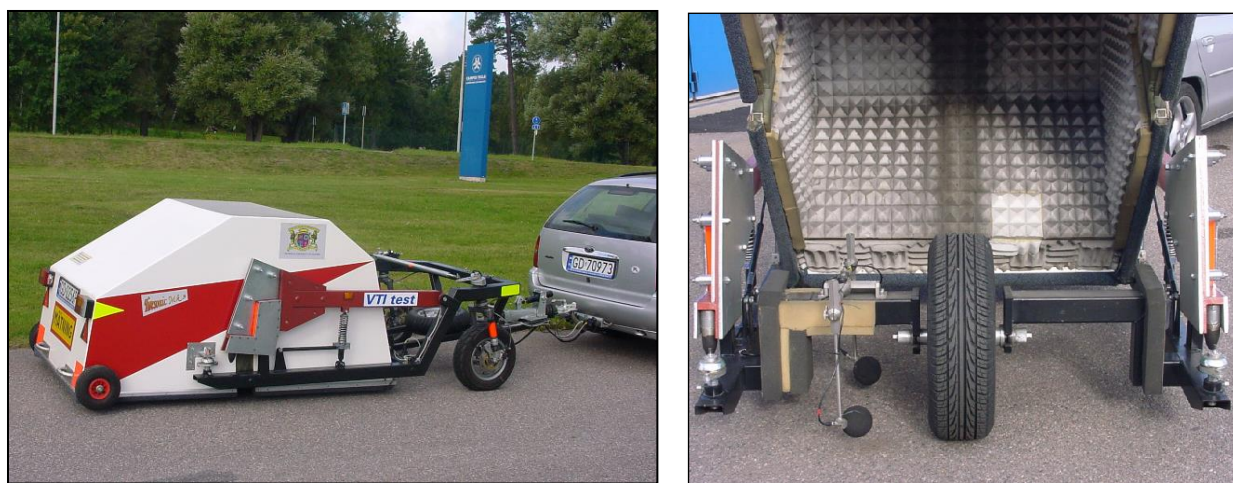
Figur 6. Utrustning från Gdansk Tekniska Universitet för mätning av buller enligt CPX-metoden [13].
